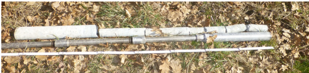
Foto 3.3: Dokumentace vývrtu ke zjištění tloušťky opěry - sonda SK3
