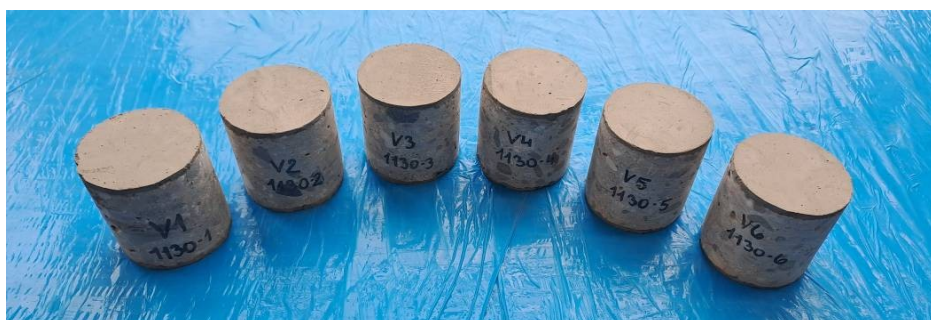
FOTO č.3.2: Dokumentace vývrtů odebraných z roznášecích desek základů pilířů
