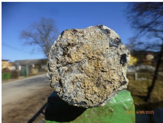
- Asfaltový nátěr v rubu opěry 2
